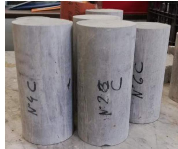
**Campioni ottenuti tramite Cased pipe sampler
