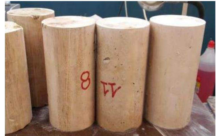
**Campioni ottenuti tramite Cased pipe sampler
